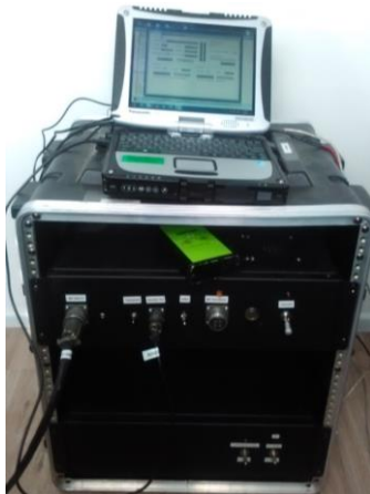
Fig. 4. Computador de terreno, receptor sistema de perfilamiento, GPS Javad y unidad de alimentación de sistema integrado.
