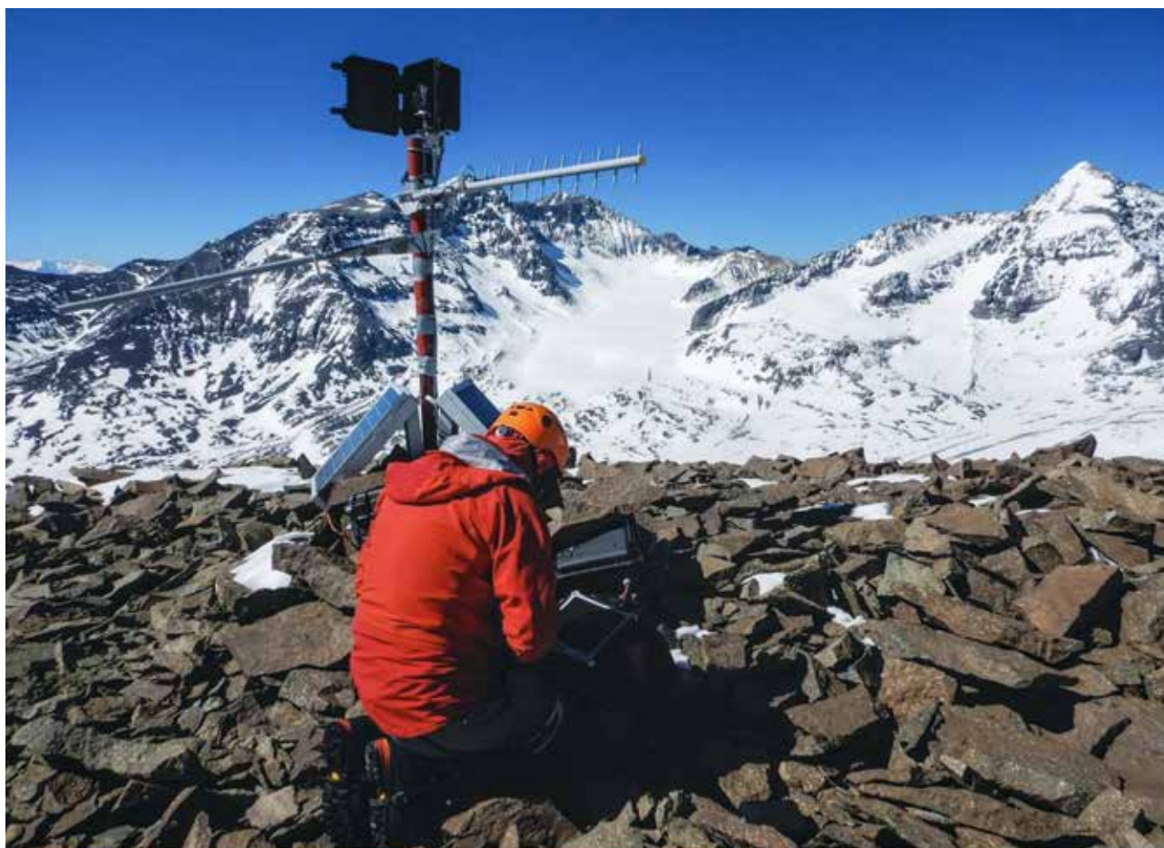
Trabajos del CECs en la cuenca alta del río Olivares. Instalación de cámara fotográfica con transmisión en línea apuntando a los glaciares Olivares y Alfa.
